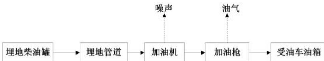
图 3-5 柴油加油工艺流程及产污节点图
